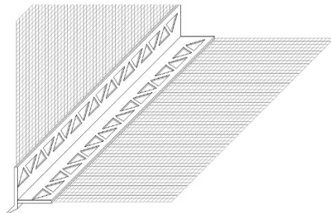
**Produktbezeichnung:** Gewebe-Eckschutzschiene mit Tropfkante
